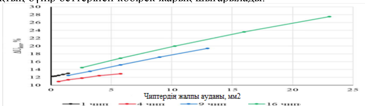
Сурет 3.13 - Чип модуліндегі оптикалық қуат шығынының чиптің жалпы ауданынан тәуелділігі. Нәтижелер ұзындығы жағынан 0.4 мм-ден 1.2 мм-ге дейін чиптер үшін ұсынылған
