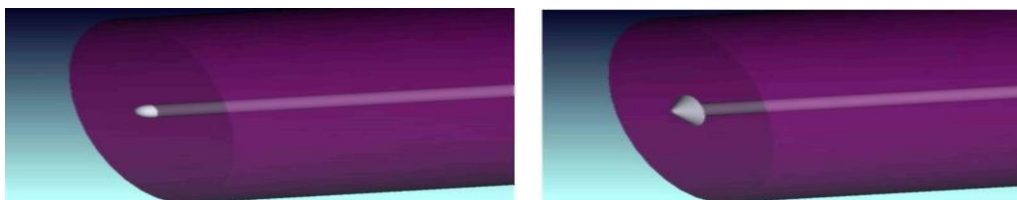
Сурет 5.6 - Линзасы бар оптикалық талшықты және бүйірдегі конус
