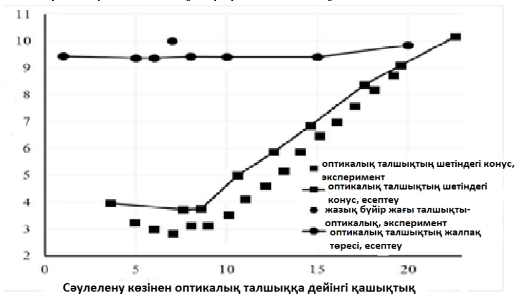
Сурет 5.2 - Тәуелділік шығынын сәуле арақашықтық сәулелену көзіне дейін талшықты-оптикалық деректер - эксперимент
